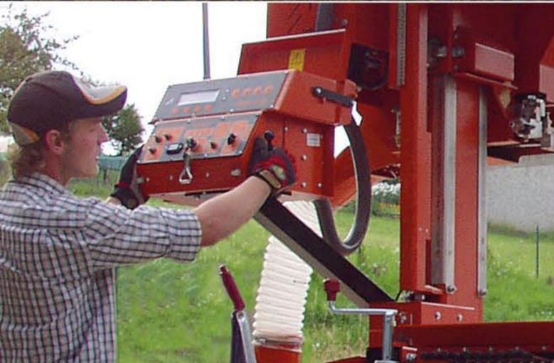
Schnittstärkencomputer an der Mobilsäge. Jeder Stamm kann mit einer anderen Aufteilung gesägt werden. Dadurch sind individuelle, flexible und effektive Holzschnitte möglich.
